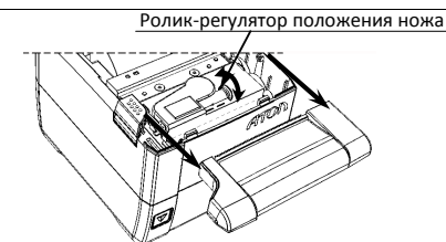
Рисунок 4. Ролик-регулятор положения ножа автоотрезчика
