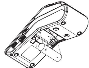
Рисунок 2. Установка аккумулятора
